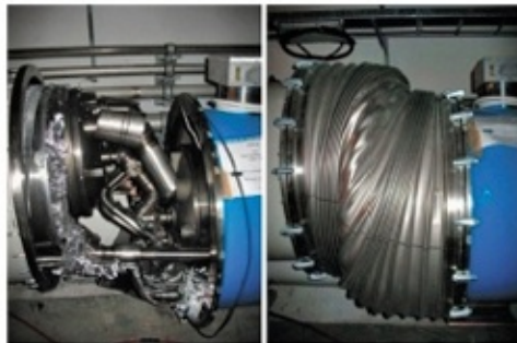
Daños sufridos por los imanes del LHC tras el accidente del 19 de septiembre. © CERN
