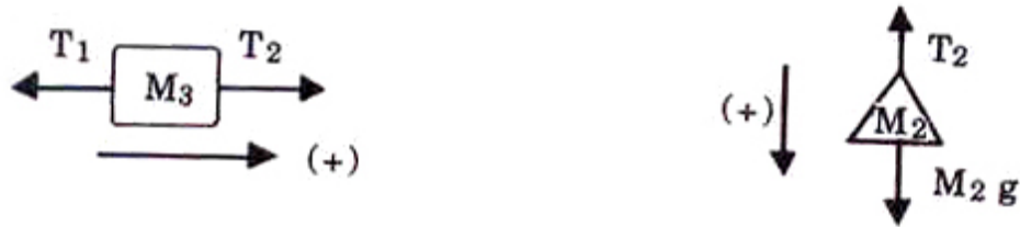
Figura VI.15: Diagrama de cuerpo libre para el caso d). Si M_2 > M_1 , entonces a > 0 , y el sistema se acelera en el sentido indicado en la Figura. Si M_2 < M_1 , a < 0 y el sistema se mueve en el sentido opuesto.
