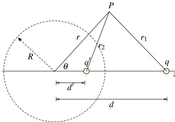
Figura 5.9: Configuración Carga Imagen Esfera conectada a tierra
