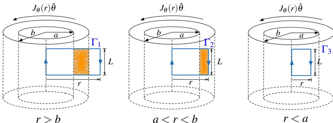
Figura 12.3: Los caminos  $\Gamma_1$ ,  $\Gamma_2$  y  $\Gamma_3$  son los que se usan para determinar el campo magnético para la densidad de corriente en  $\theta$  (en naranja la corriente enlazada por los caminos).
