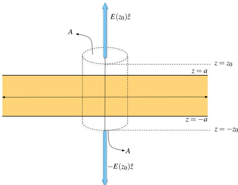
Figura 4.5: Superficie Gaussiana para  $|z| > a$
