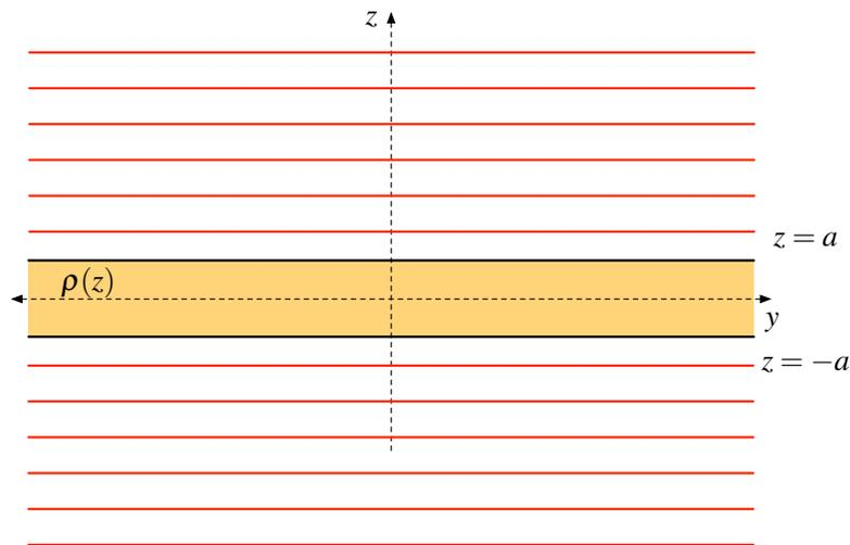
Figura 4.7: Equipotenciales paralelas al plano  $xy$  (en rojo).
