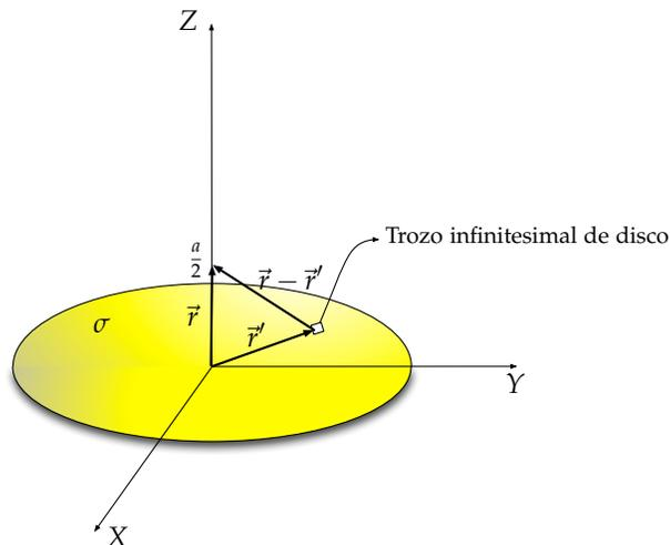
Figura 2.1: Campo Eléctrico generado por un disco.
