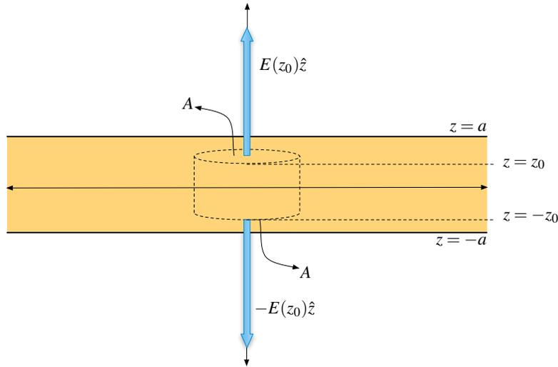
Figura 4.4: Superficie Gaussiana para  $|z| \leq a$
