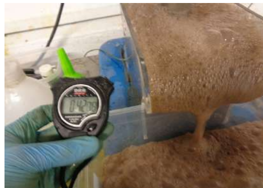
Prueba de separación magnética en tubo de Davis. FUENTE: Imágenes tomadas en laboratorio del CI-JRI por el Programa 16PTECME-66527.
