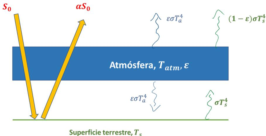
**Figura 2: Esquema de balance radiativo terrestre para una condición con atmósfera homogénea, permeable a la radiación solar pero opaca para la radiación termal.**
