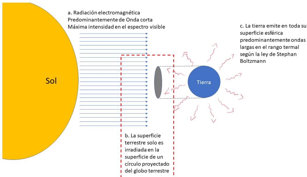
**Figura 1: Esquema de balance radiativo terrestre para una condición sin atmósfera.**
