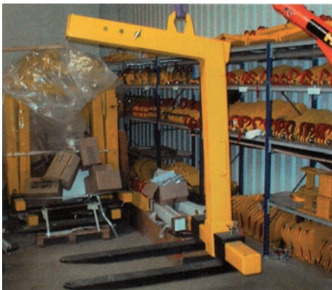
Transporta palets Tipo GAH con sistema de equilibrado automático y altura regulable
