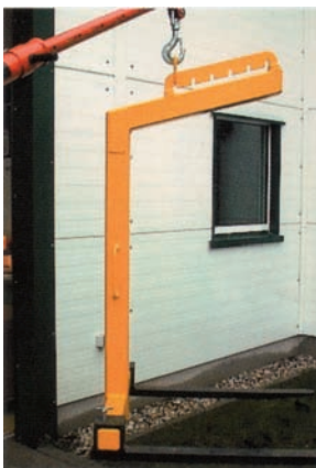
Transporta Palets Tipo GM con sistema de equilibrado manual
