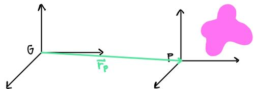
$$I_{ij}^P = I_{ij}^G + M(r_G^2 \delta_{ij} - r_{Gi} r_{Gj})$$
