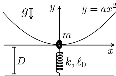
(a) Si el anillo se encuentra inicialmente en el punto más bajo de la parábola, determine la velocidad  $v_0$  con que se le debe impulsar para que alcance una altura  $D$  sobre la posición inicial.
