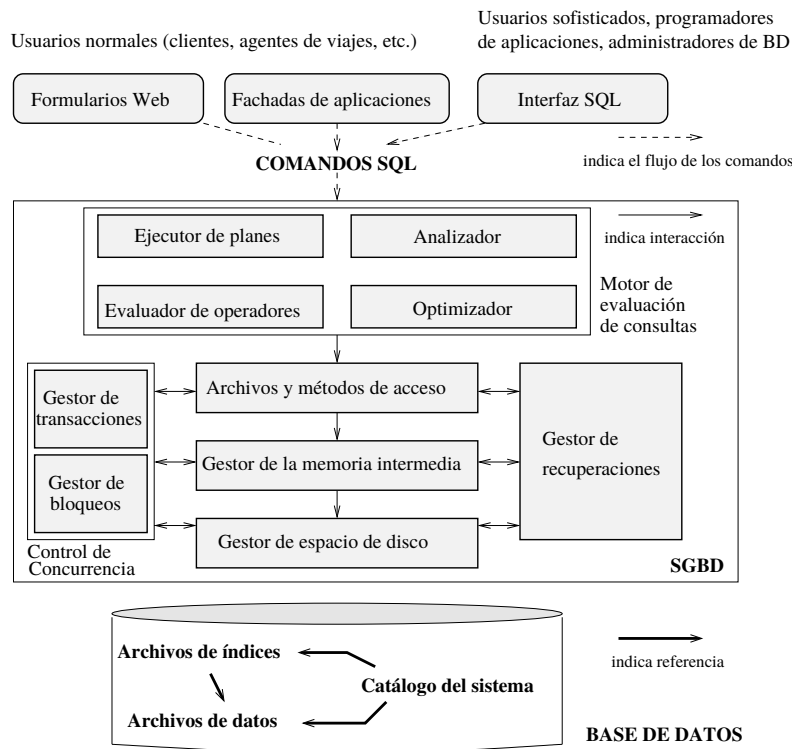
Figura 1.3 Arquitectura de un SGBD
