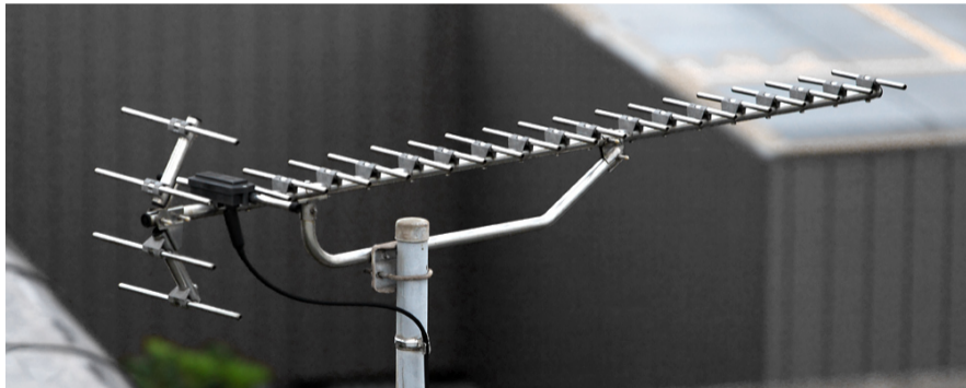
Figura: Antena de televisión. La detección de la frecuencia frente de ondas es dependiente del largo de la antena ( \lambda/2 ).
