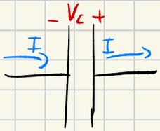
Como la corriente entra por el lado negativo de  $V_C$ , a medida que corre corriente se descarga el condensado  $I = \frac{dQ}{dt}$
