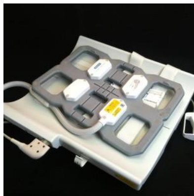
Figura 22: Bobina de abdomen multireceptora. Varias bobinas pequeñas en anillo combinadas para formar una más grande.
