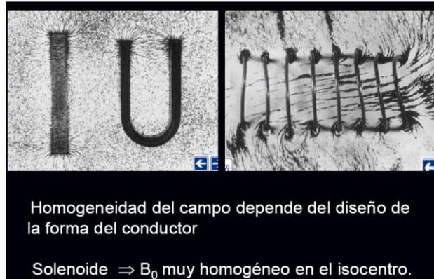
Figura 2: Tipo de magneto, forma del conductor y líneas de fuerza de  $B_0$
