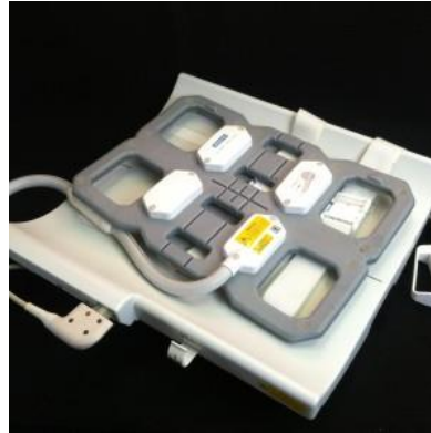
Figura 19: Bobina de abdomen en array. Varias bobinas pequeñas en anillo combinadas para formar una más grande.
