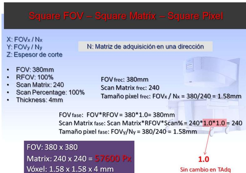
Figura 5: Adquisición sin RFOV y sin Phase Resolution
