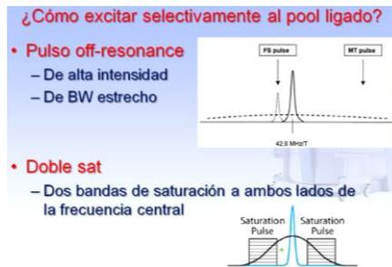
Figura 25: Excitación selectiva del Pool B, mediante pulso off-resonance o con doble sat
