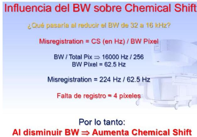
Figura 10: Cálculo del Misregistration con Dim-Frec de 256 y rBW de 16 KHz
