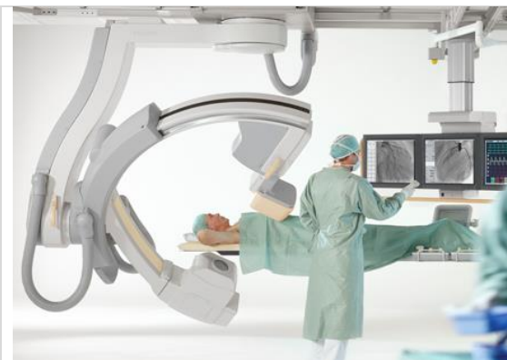
Figura n°9 A: Equipo de angiografía de última generación que permite obtener imágenes seriadas
