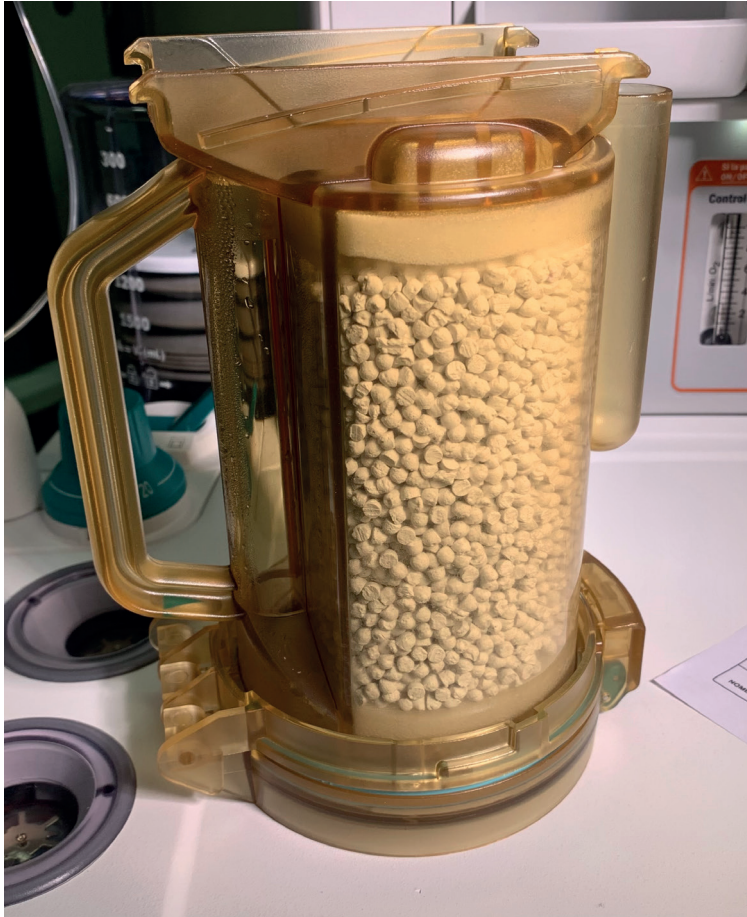
Figura 14.3. Canister con cal sodada en su interior.
