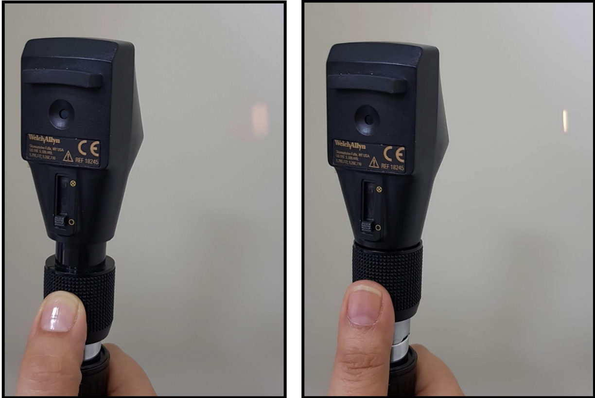
Figura 4: A la izquierda se muestra el reflejo a 30 cms. en posición de espejo plano. A la derecha en posición de espejo concavo.
